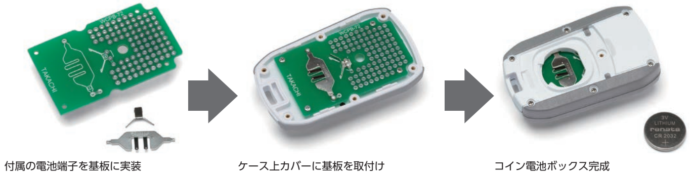
付属の電池端子を基板に実装
